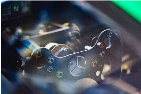
*Der Mercedes-AMG GT3 #18 kommt dank Space Drive ganz ohne mechanische Verbindung zwischen Lenkeinheit und Lenkgetriebe aus, Foto: GruppeC Photography*
